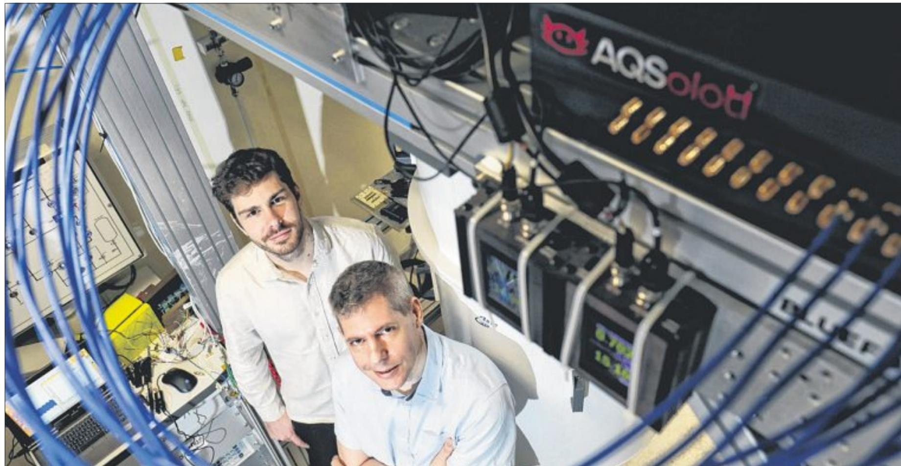
AQSolotl联合创始人兼首席执行官博尔（左）和南大物理学家杜姆克副教授，向记者展示最新研制的量子控制器。图中右上黑色部件为控制器，所释放的电磁波通过蓝色电缆，对处于超低温环境中的量子晶片进行操控，达到计算目的。（何炳耀摄）
